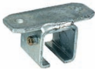
Deckenbefestigung, pulverbeschichtet, für C-Profil, 40x40 mm, inkl. Dübel und Schrauben / Ceiling mounting, powder-coated, for C-sections, 40x40 mm, incl. wall plugs and screws / Support de plafond, peint par pulvérisation, pour des profilés en C, 40x40 mm, avec chevilles et vis
