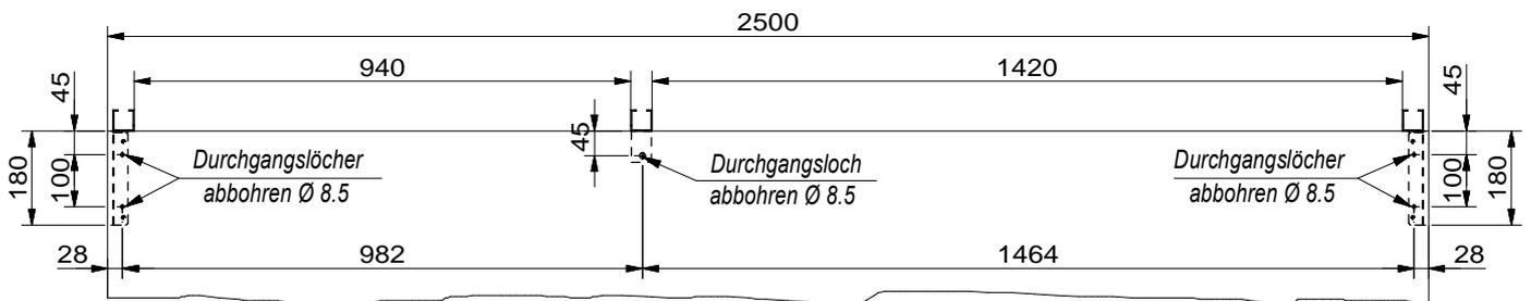
bei Plattenlänge 2500 mm außermittig 1 x Mittelaufbaustütze
