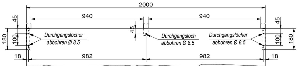
bei Plattenlänge 2000 mm mittig 1 x Mittelaufbaustütze
